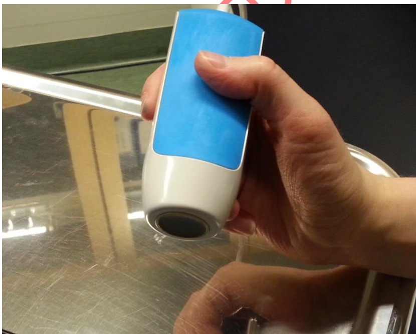
Kuva 30: Anturin pään tulee olla vapaana ilmassa ennen kuin KALIBROI -nappia painetaan.
