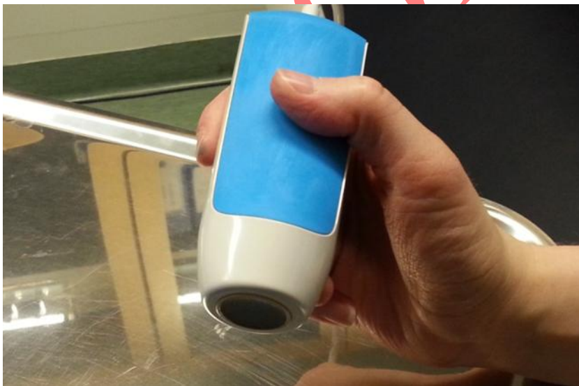
Kuva 45: Anturin pään tulee olla vapaana ilmassa ennen kuin KALIBROI -nappia painetaan.
