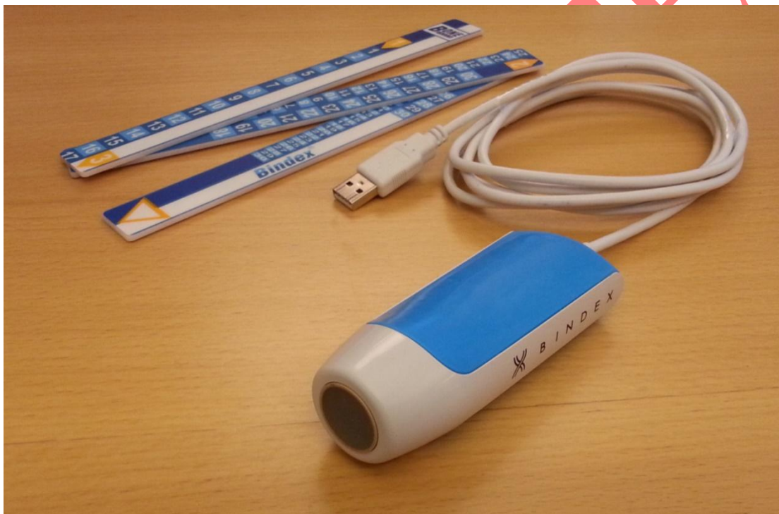
Kuva 2: Bindex® -laite yhdessä Bindex® BI-41 Measure -mitan kanssa.
